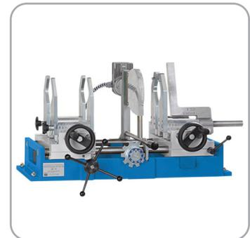
Die WIDOS 35xx/11 kann sowohl in der Werkstatt, also auch auf der Baustelle und im Graben eingesetzt werden. Die Maschinen werden inkl. Heizelement und Prismenspannwerkzeug geliefert.
