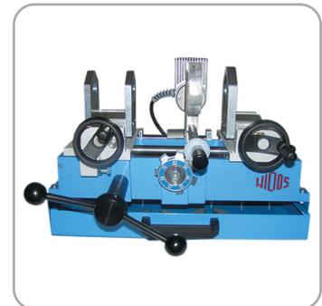
Die WIDOS 7511 kann auf der Baustelle und im Graben eingesetzt werden. Rohre und Formteile von DA 20 bis DA 75 werden mit der WIDOS 7511 geschweißt. Die Maschine ist optisch an die WIDOS 3511 angelegt. An der Grundmaschine sind ein elektronisch geregeltes Heizelement und das Prismenspannwerkzeug angebracht. Die Grundmaschine hat eine Schublade zur Unterbringung aller Spannwerkzeugelemente.
